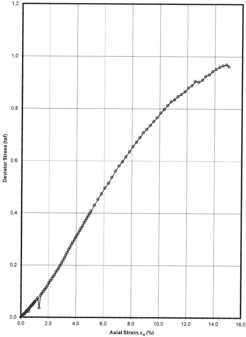
**UNCONSOLIDATED-UNDRAINED TRIAXIAL COMPRESSION TEST**
