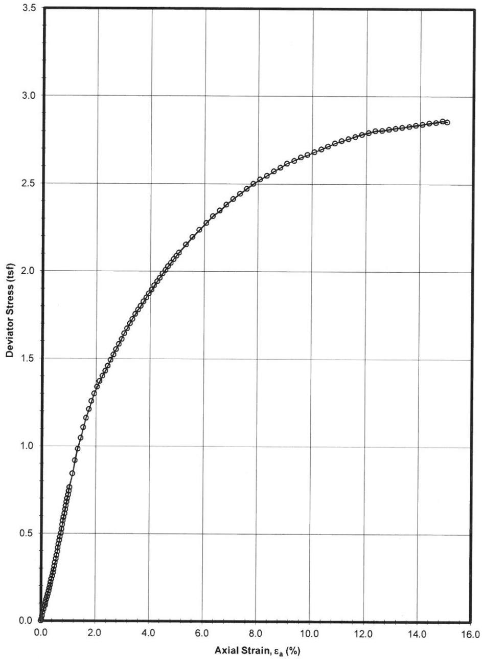
**UNCONSOLIDATED-UNDRAINED TRIAXIAL COMPRESSION TEST**
