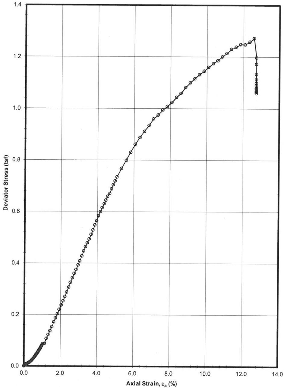
**UNCONSOLIDATED-UNDRAINED TRIAXIAL COMPRESSION TEST**
