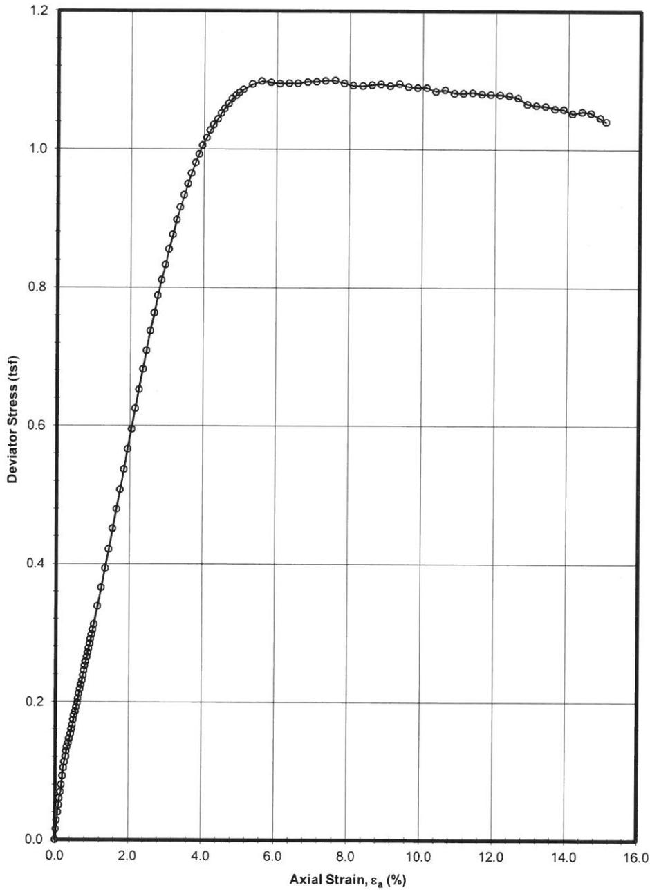
**UNCONSOLIDATED-UNDRAINED TRIAXIAL COMPRESSION TEST**
