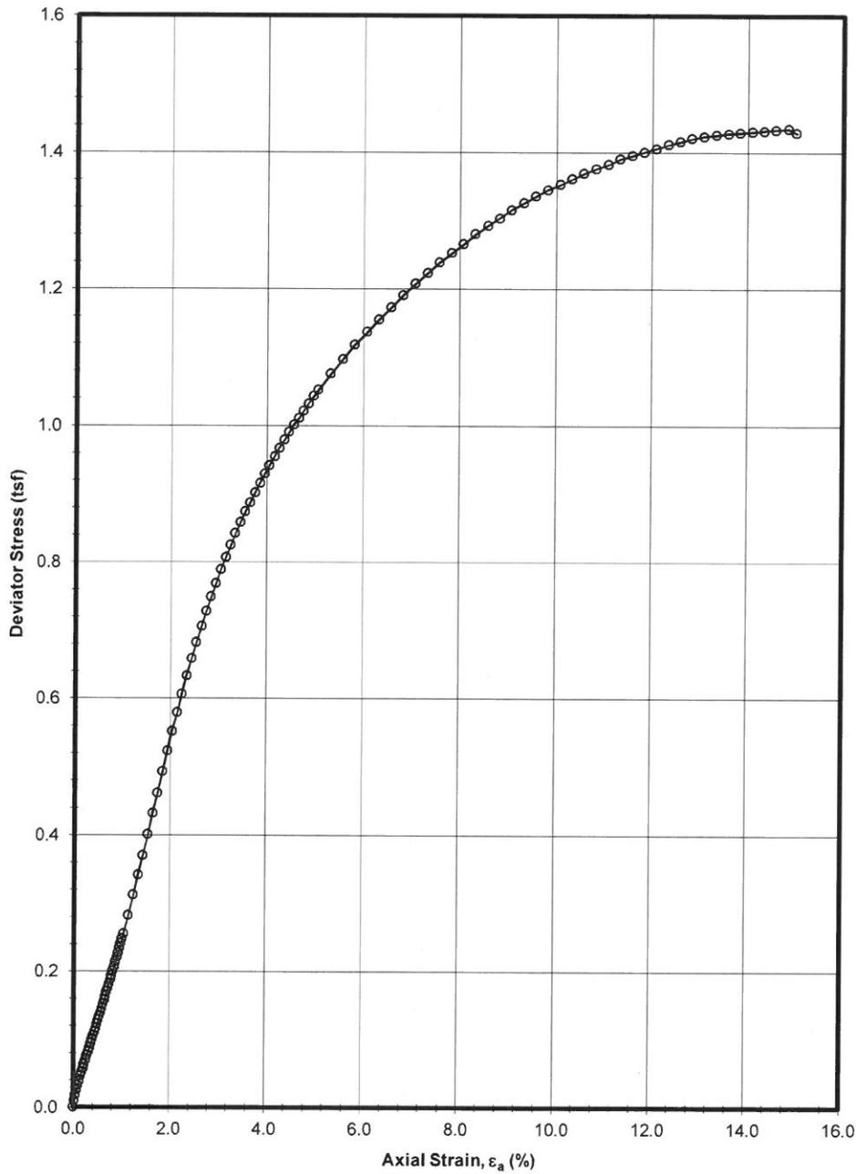
**UNCONSOLIDATED-UNDRAINED TRIAXIAL COMPRESSION TEST**
