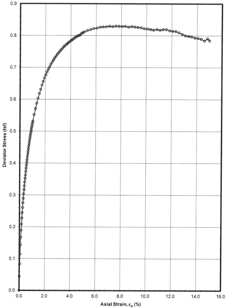
**UNCONSOLIDATED-UNDRAINED TRIAXIAL COMPRESSION TEST**
