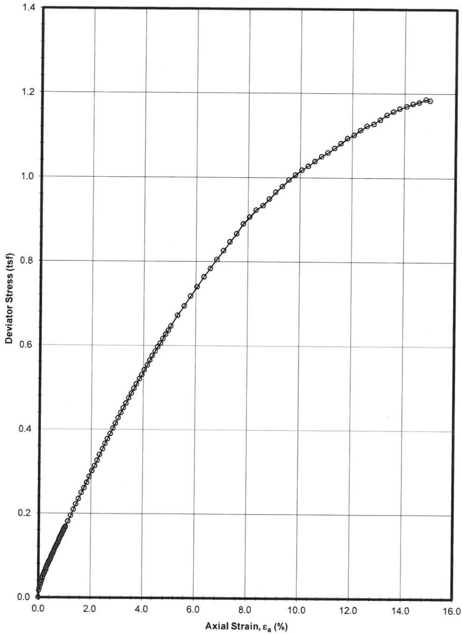
**UNCONSOLIDATED-UNDRAINED TRIAXIAL COMPRESSION TEST**
