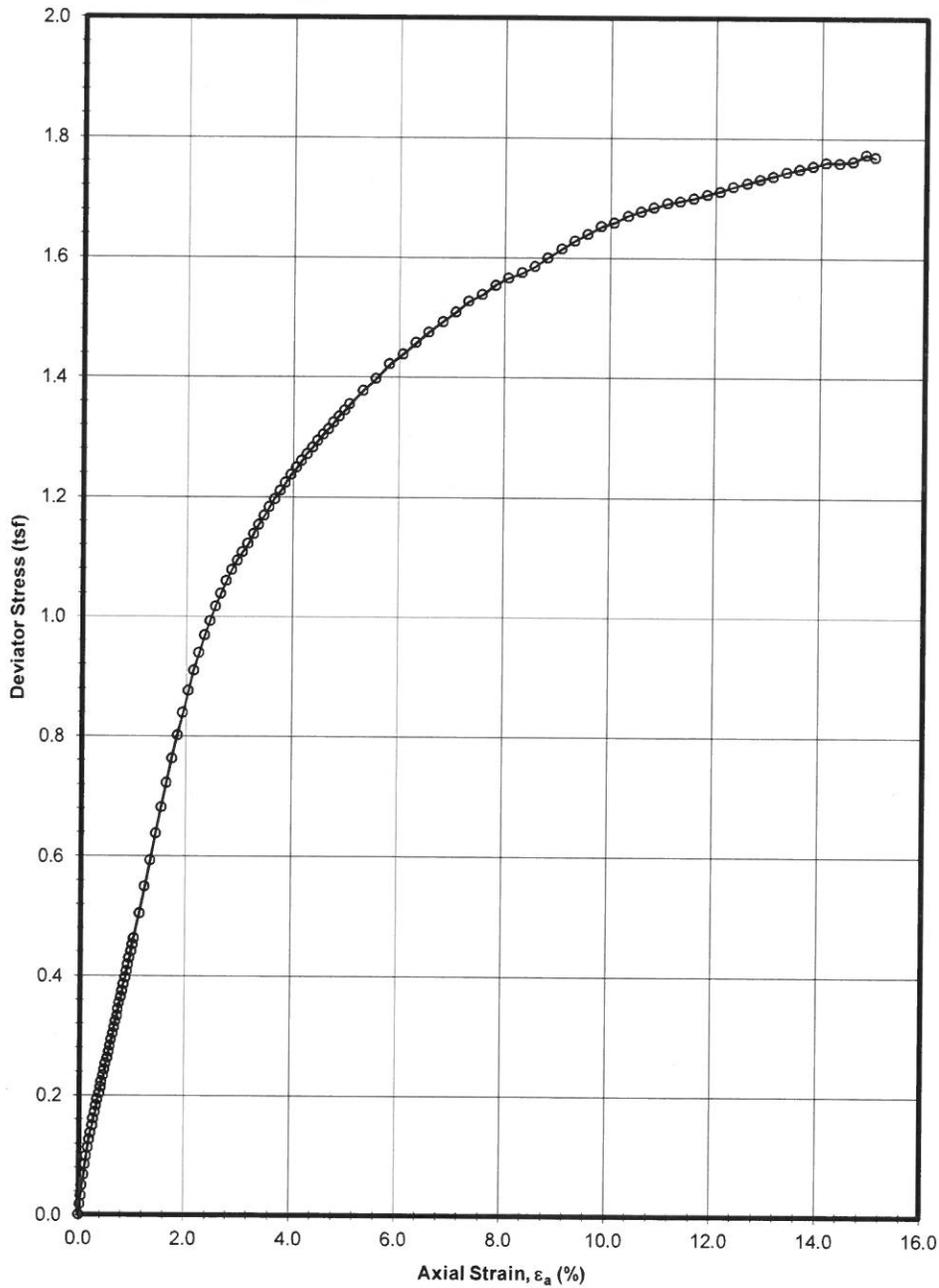
**UNCONSOLIDATED-UNDRAINED TRIAXIAL COMPRESSION TEST**
