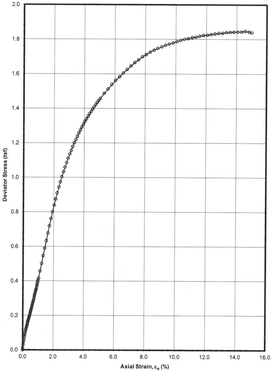
**UNCONSOLIDATED-UNDRAINED TRIAXIAL COMPRESSION TEST**
