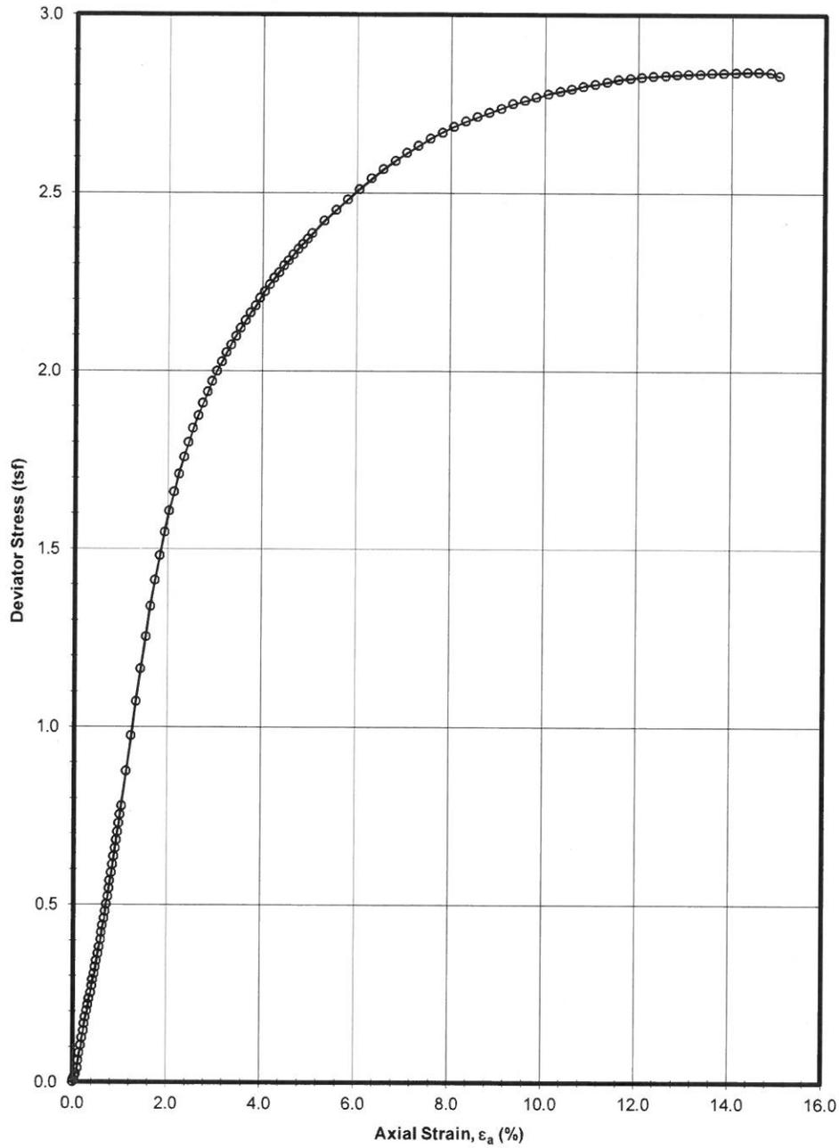
**UNCONSOLIDATED-UNDRAINED TRIAXIAL COMPRESSION TEST**
