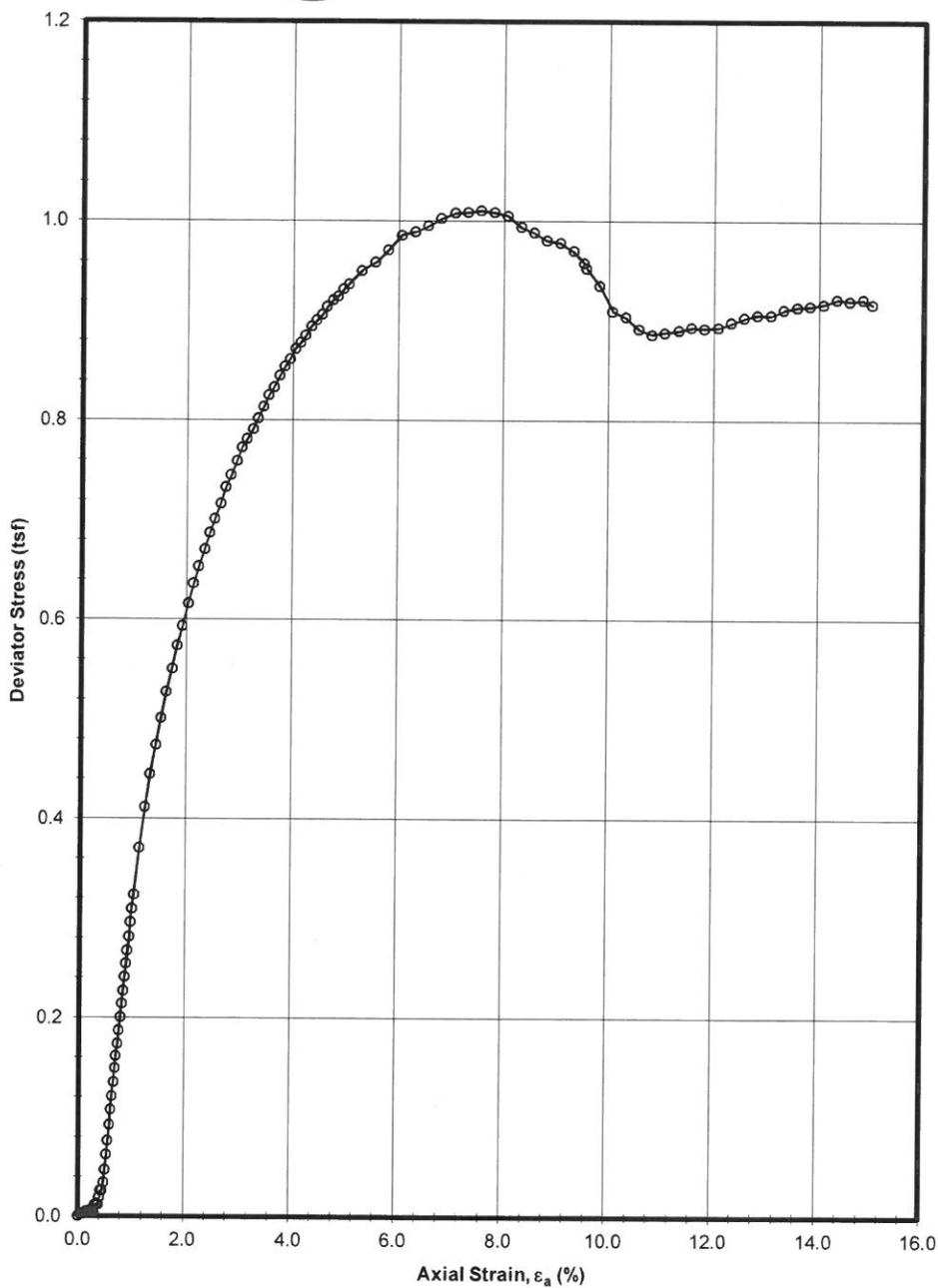
**UNCONSOLIDATED-UNDRAINED TRIAXIAL COMPRESSION TEST**
