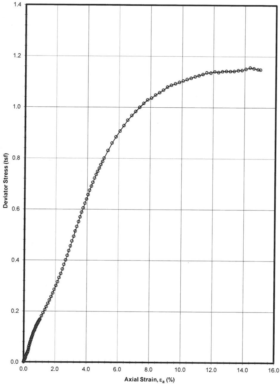
**UNCONSOLIDATED-UNDRAINED TRIAXIAL COMPRESSION TEST**
