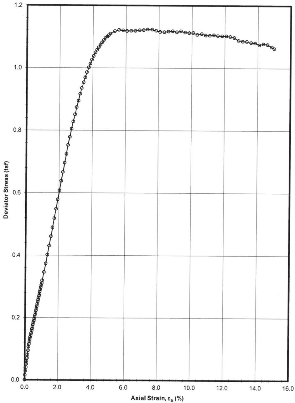
**UNCONSOLIDATED-UNDRAINED TRIAXIAL COMPRESSION TEST**
