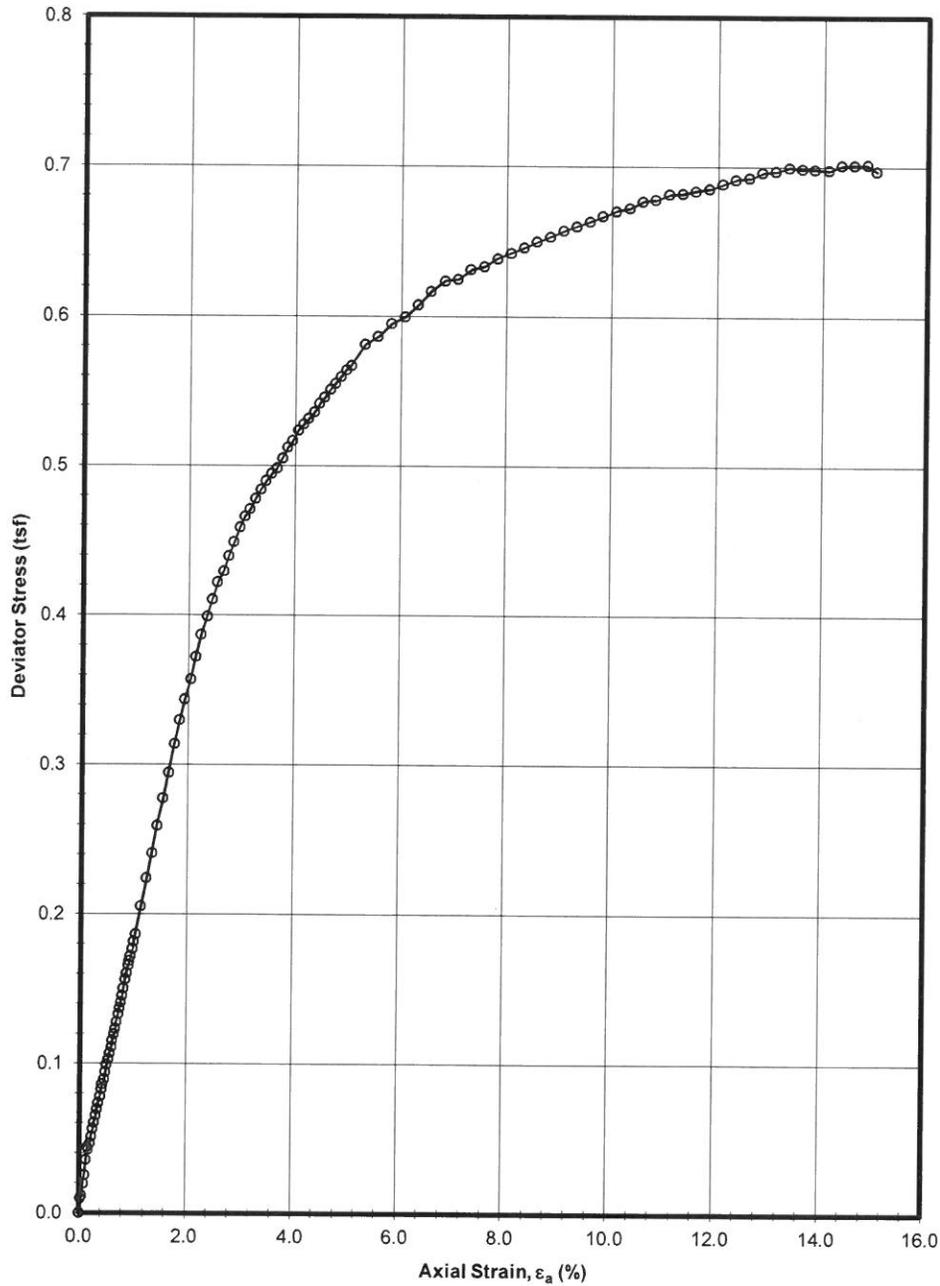
**UNCONSOLIDATED-UNDRAINED TRIAXIAL COMPRESSION TEST**
