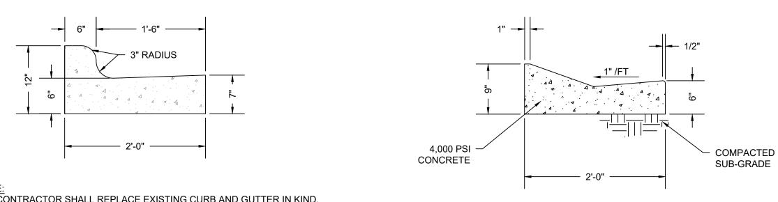
24" ROLL-OVER CURB & GUTTER DETAIL
