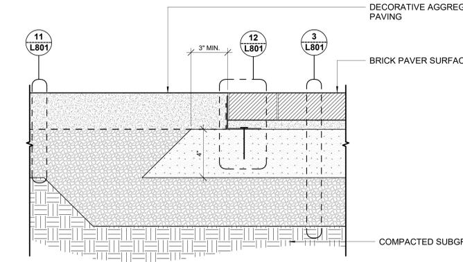
10 PAVER TO AGGREGATE PAVING TRANSITION
