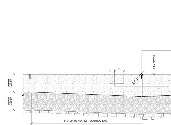
7 CONCRETE SLAB EXPANSION JOINT
