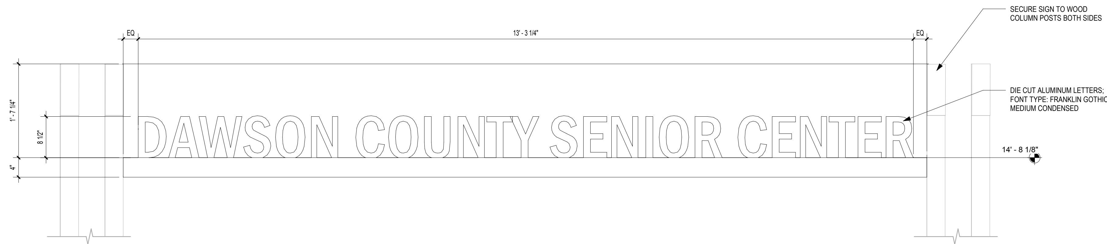
2 SIGN TYPE E - EXTERIOR SCALE: 1" = 1'-0"
