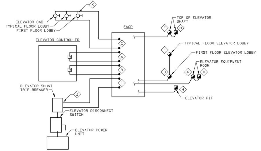
**ELEVATOR CONTROLLER/FACP INTERCONNECTION DIAGRAM**
