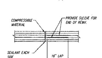
4 TYPICAL CONTROL JOINT AT BOND BEAM
