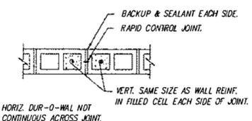
5 TYPICAL MASONRY WALL CONTROL JOINT (M.C.J.)
