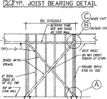
11 TYPICAL STEEL CROSS BRACING SHEAR WALL ELEVATION
