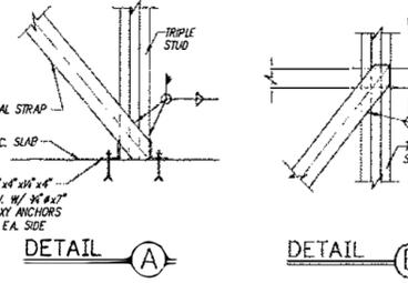
12 TYPICAL FLAT STRAP LATERAL BRACING ELEVATION
