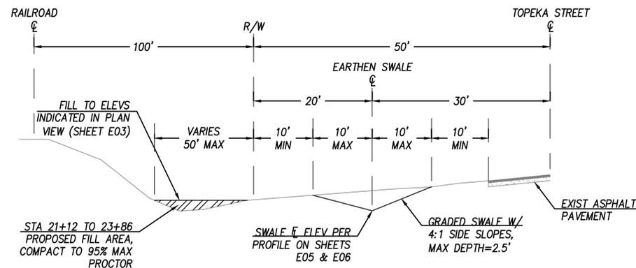
**C** EARTHEN SWALE & FILL AREA CROSS SECTION
