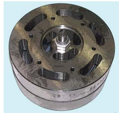
*Figure 24. Compressor Valve*
