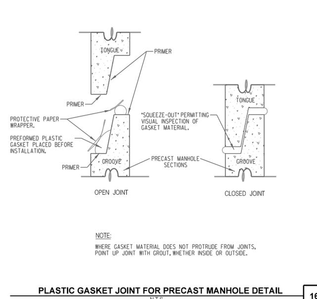
PLASTIC GASKET JOINT FOR PRECAST MANHOLE DETAIL
