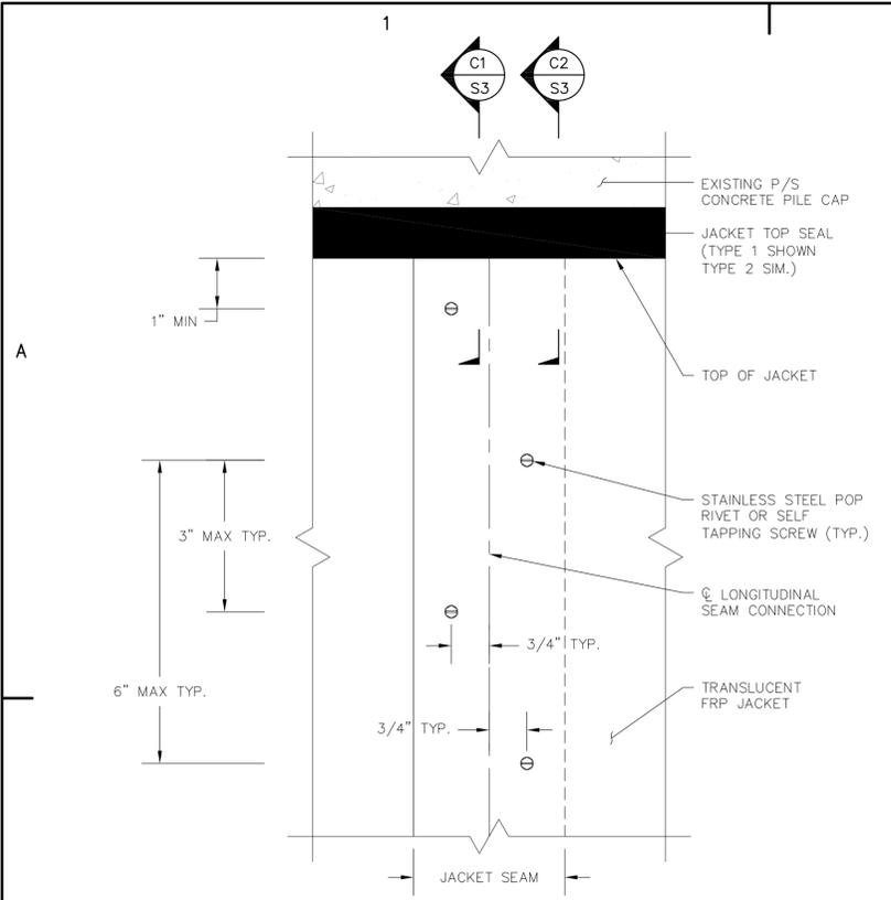
**A1 S3** **DETAIL - JACKET TOP SEAL CONNECTION**
