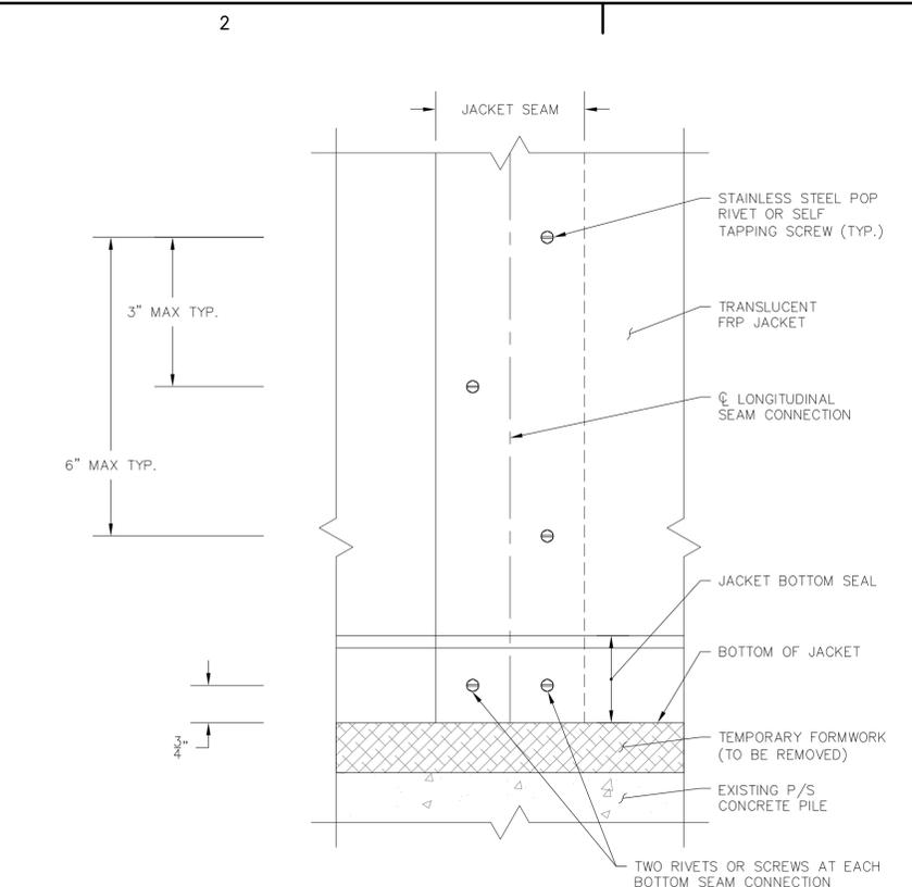
**A2 S3** **DETAIL - JACKET BOTTOM SEAM CONNECTION**
