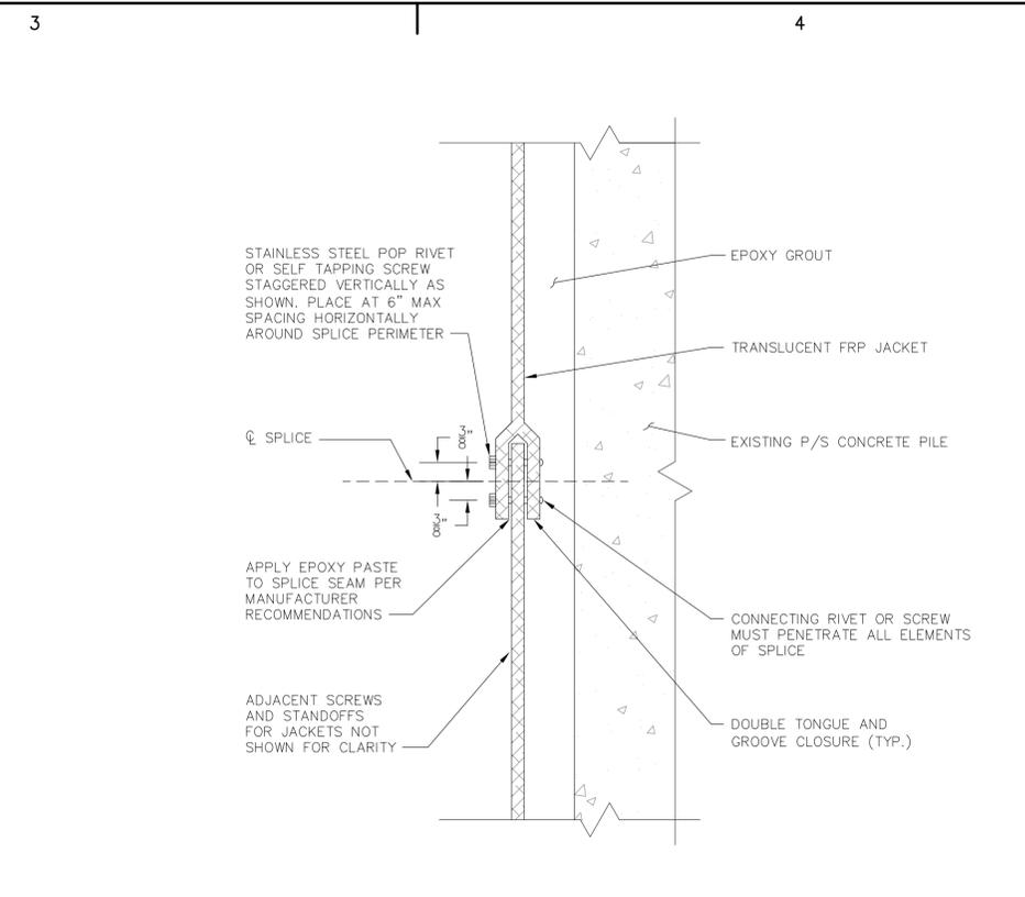
**A4 S3** **DETAIL - JACKET MID SEAM CONNECTION (WHERE REQUIRED)**
