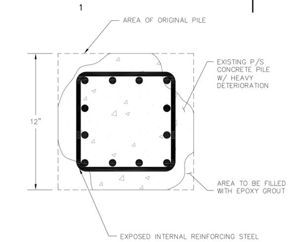
**TYP DETERIORATED PILE CROSS SECTION**
