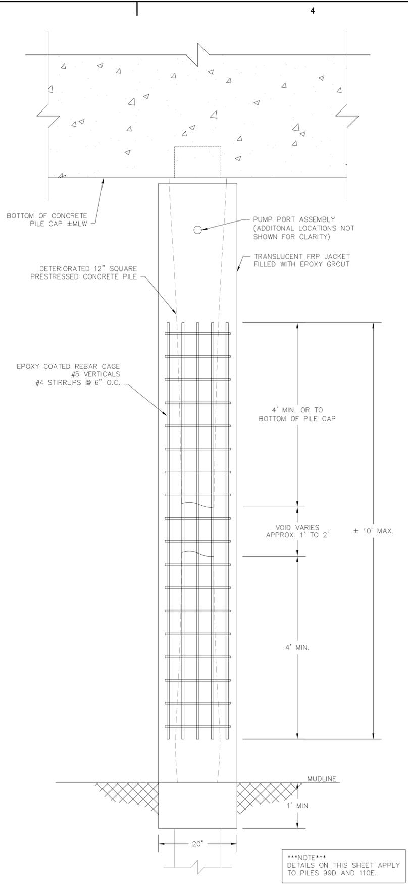
**TYPICAL PILE JACKET W/ REBAR CAGE ELEVATION**
