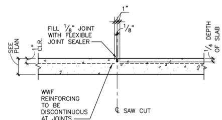
**TYP. CONTROL JOINT SLABS ON GRADE** 2
