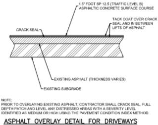
ASPHALT OVERLAY DETAIL FOR DRIVEWAYS
