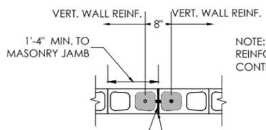
**B MASONRY WALL CONTROL JOINT TYPICAL**
