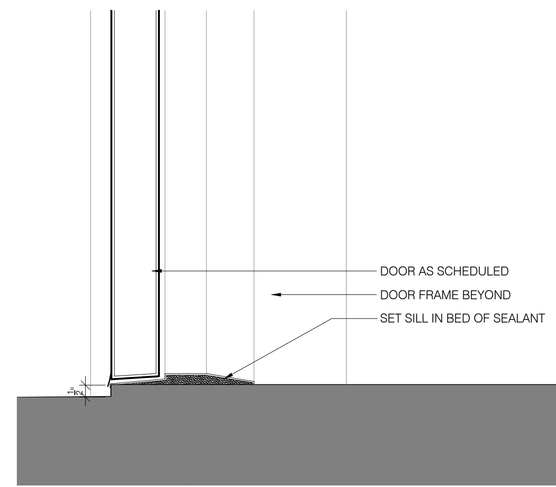
6 SILL DETAIL SCALE: 3" = 1'-0"
